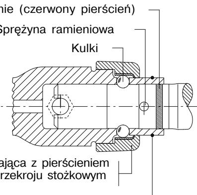
Nakrętka zamykająca z pierścieniem dociskowym o przekroju stożkowym
