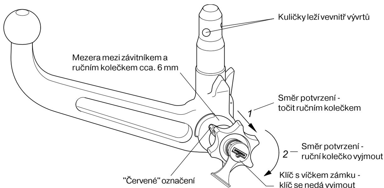
Tilladelsesnummer iflg. retningslinie 94/20/EU: **e13 00-0906**Klasse: **A50-X** Type: **314 251**Tekniske specifikationer: Maksimal D-værdi: **9,3 kN**Maksimal støttelast: **75 kg**
