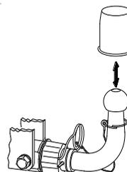
**Smontaggio e rimontaggio dell'asta a sfera**
