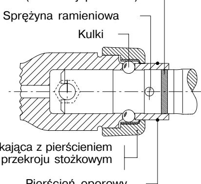
Nakrętka zamykająca z pierścieniem dociskowym o przekroju stożkowym
