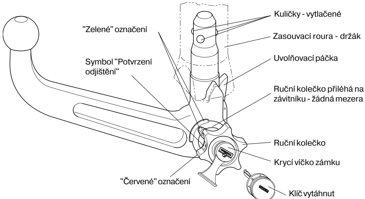
**Odjištěná pozice Vyndání kulové tyče**
