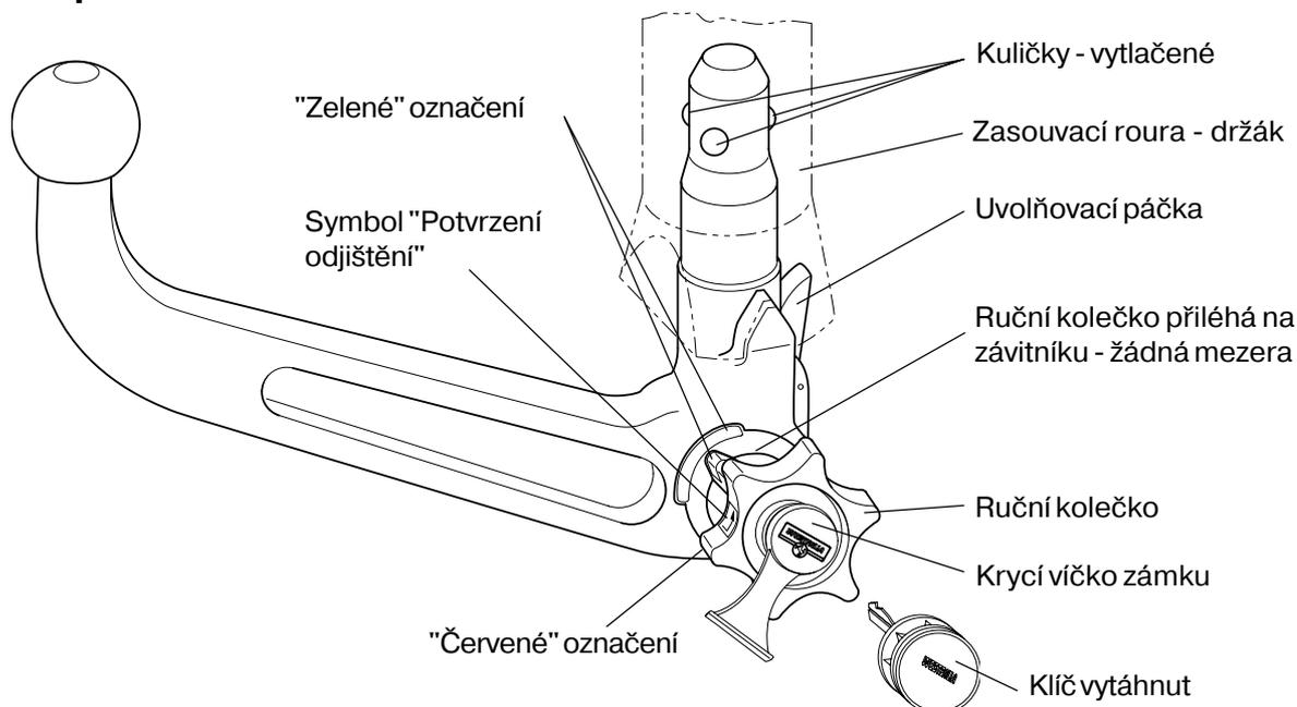
**Odjištěná pozice Vyndání kulové tyče**
