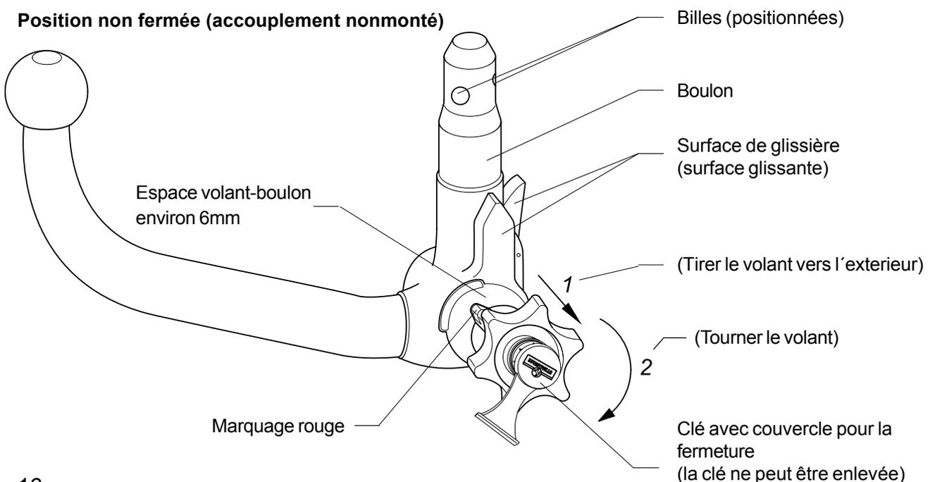
Direktiivin 94/20/EG mukainen hyväksymisnumero: **e13 00-1278**Luokka: **A50-X** Tyyppi: **332 198**Tekniset tiedot: Suurin D-arvo: **9,6 kN**Suurin koukkukuorma: **75 kg****Käyttökohteet:** Ajoneuvonvalmistaja: **Nissan**Malli: **Primera**yppimerkintä: **P12E**
