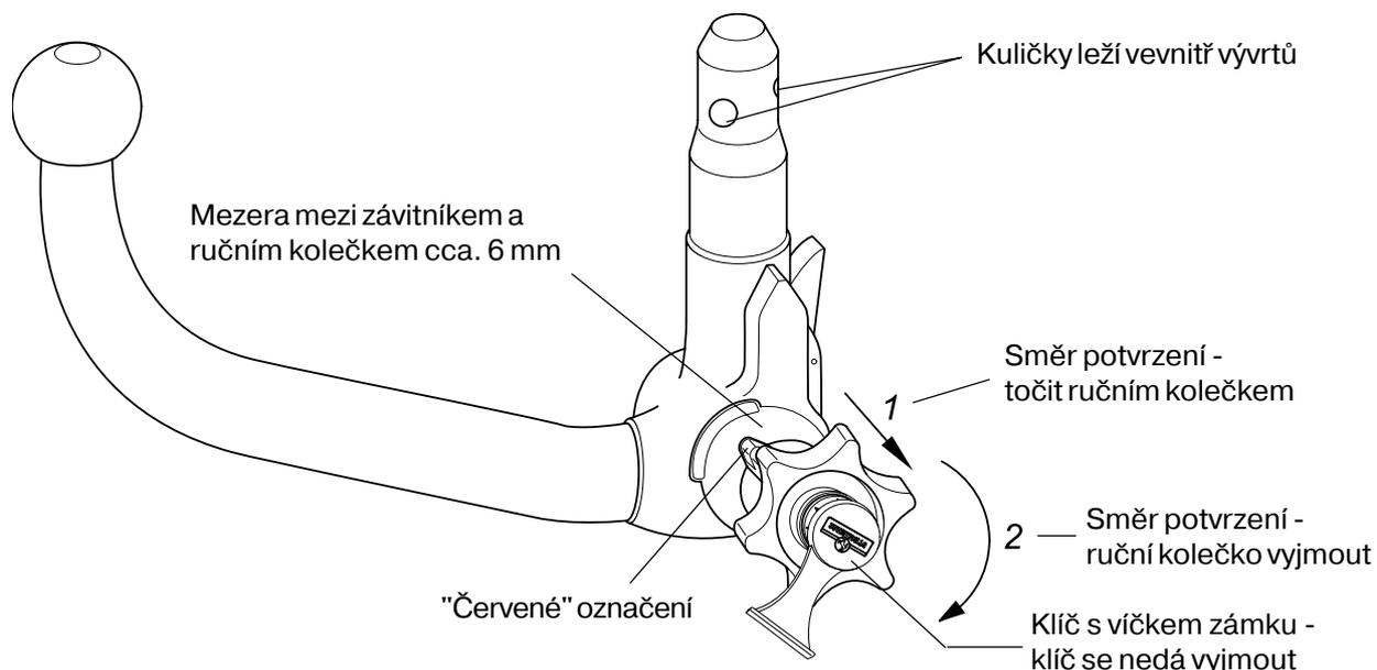
Tilladelsesnummer iflg. retningslinie 94/20/EU: **e13 00-1278**Klasse: **A50-X** Type: **332 198**Tekniske specifikationer: Maksimal D-værdi: **9,6 kN**Maksimal støttelast: **75 kg**
