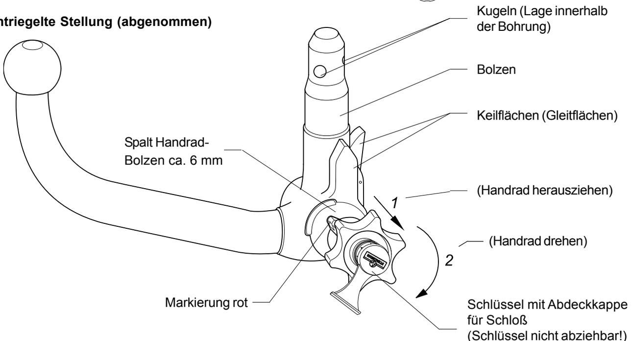
Číslo povolení podle směrnice 94/20/EG: **e13 00-1278**Třída: **A50-X** Typ: **332 198**Technické údaje: maximální D-hodnota: **9,6 kN**maximální zatížení podpěry: **75 kg**
