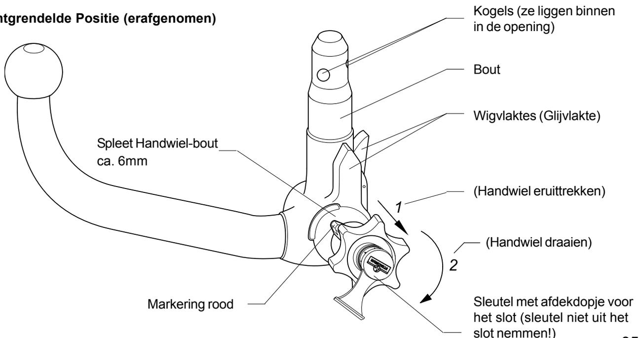
Tillståndsnummer enligt Riktlinje 94/20/EG: **e13 00-1278**Klass: **A50-X** Typ: **332 198**Tekniska data: maximalt D-värde: **9,6 kN**maximalt stödlast: **75 kg**
