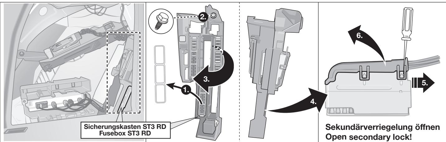
**Sicherungskasten ST3 RD / Fusebox ST3 RD**
