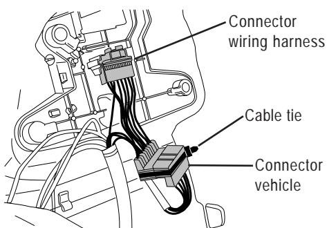
INSTRUCTION DE MONTAGE DU FAISCEAU ELECTRIQUE POUR CROCHET D'ATTELAGE
