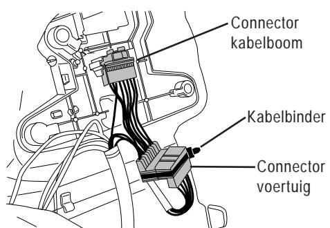
5. Leid de bruin/witte draad van de accu, langs de linkerzijde door het voertuig naar de 3-polige connector van de kabelboom.
